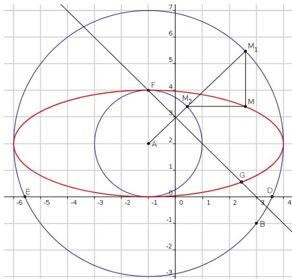
6. A l'aide des deux cercles (C) et (C'), tracé de l'ellipse de centre A et de demi-axes  $a = 5$  et  $b = 2$  avec l'affinité orthogonale (page précédente).
